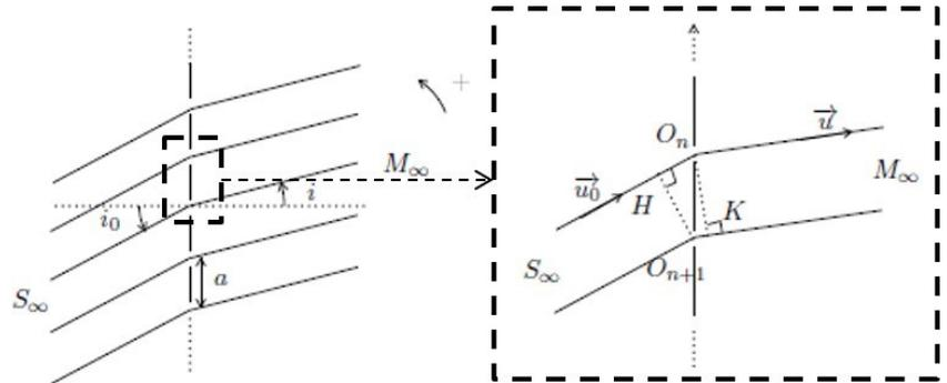
On obtient donc la **formule des réseaux**, qui nous donne la valeur de l'angle d'émergence,  $i_p$ , du réseau pour une frange brillante en fonction de l'angle d'incidence,  $i_0$ , et de l'ordre d'interférence  $p$  entier :
